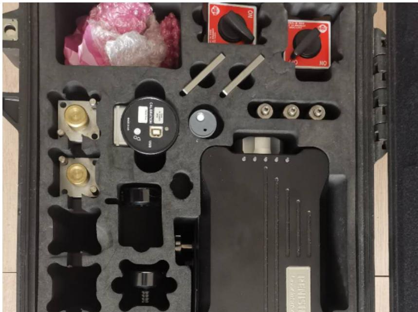
激光干涉仪，以激光波长为已知长度，利用迈克耳逊干涉系统测量位移的通用长度测量。激光干涉仪的光源——激光，具有强度较高、高度方向性、空间同调性、窄带宽和高度单色性等优点。激光干涉仪可配合各种折射镜、反射镜等来使用。可测量速度、加速度、振动等参数，并评估机床动态特性。设计用于安装在机床主轴上的5D/6D传感器。同时测量线性定位误差、直线度误差（双轴）、偏摆角、俯仰角和滚动角。可选的无线遥控传感器比较长的控制距离可到25米。仪器校准激光干涉仪求购激光干涉仪，以激光波长为已知长度，利用迈克耳逊干涉系统测量位移的通用长度测量。
