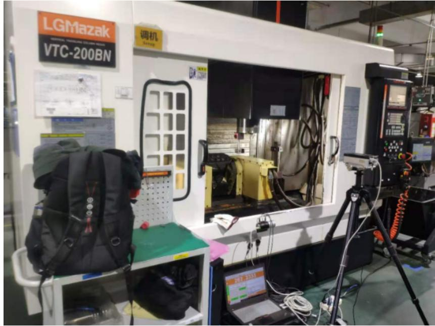
激光干涉仪初步调整后，固定分光镜并在分光镜上安装光靶，通过“整体”调整精确瞄准光靶后，取下分光镜光靶，将Z轴升高，观察激光在反光镜光靶上偏离程度，同时透过“尾部”调整使激光对准反光镜光靶，若在此过程中因“尾部”的调整导致分光镜遮挡了部分激光，则将Z轴停止上升回到起始处，重新调整“整体”，再次对准反射镜光靶。紧接着再升Z轴，继续调整“尾部”，观察激光在反光镜光靶上偏离程度。重复整个过程，往往几次即可达到准直要求。
