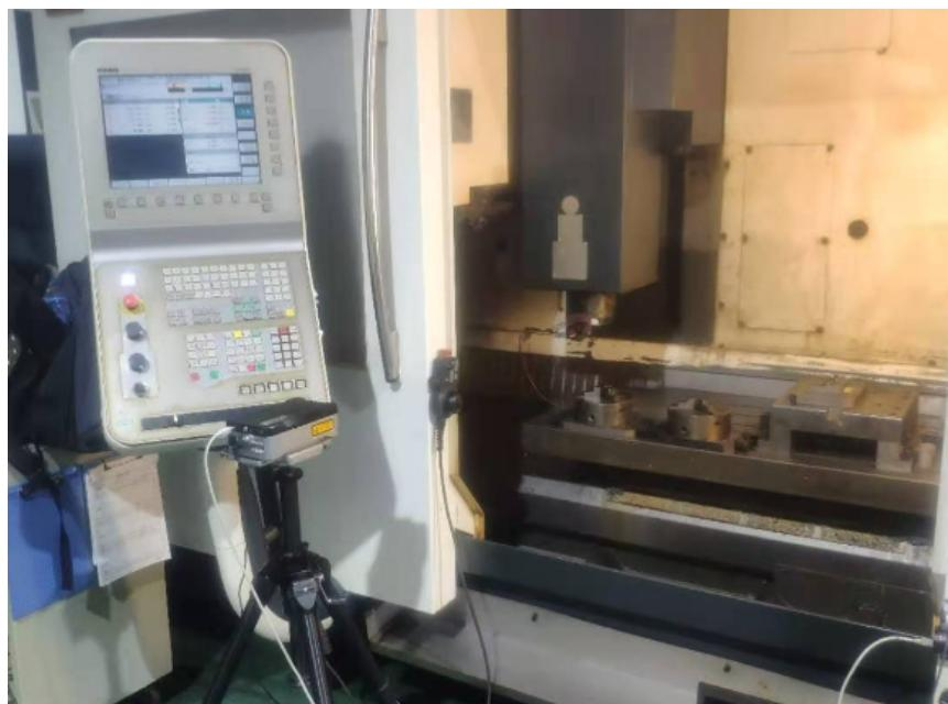
激光干涉仪具有有线性测量镜组、角度测量镜组、平面度测量组件、直线度测量组件、垂直度测量镜组、激光器准直辅助镜等等，实际使用中，有些不同功能的镜组也可以相互组合使用，以满足测量需要。比如角度测量镜组中的反射镜也可以替换线性测量镜组中的反射镜；激光器准直辅助镜的使用可以减少准直调整的时间。同时，激光干涉仪各个测量镜组也可以在别的测量工作中使用，常见的利用分光镜或者光学直角器，达到改变光路，方便测量的目的。这需要，了解设备性能、掌握测量技巧，在满足测量准确度的前提下活学活用。激光干涉仪是精度比较高的线性位移测量仪器，其光波可以直接对米进行定义。仪器校准激光干涉仪求购
